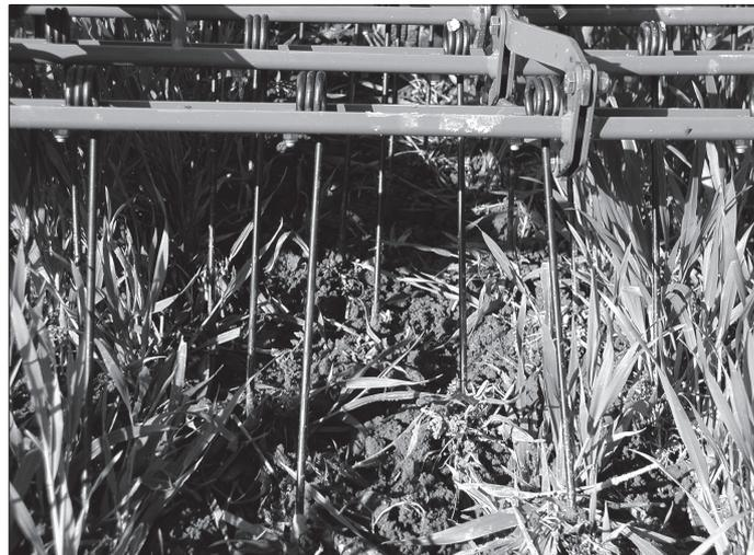
Abb. 1: Mechanische Beikrautregulation im ökologischen Ackerbau: Einsatz einer Rollhacke in Kartoffeln (links) und eines Striegels im Getreide (rechts).
